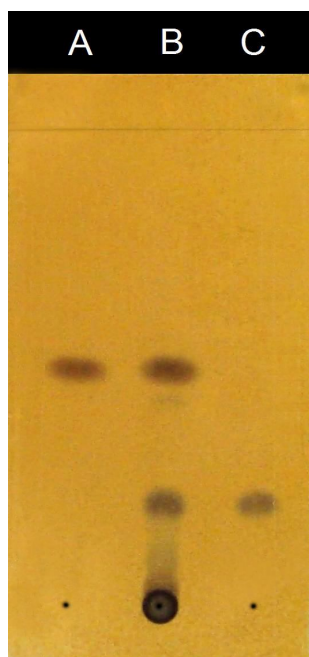
Figura 51 - Cromatograma realizado em sílica gel F 254 com extrato das folhas de uva-ursi (B) e as substâncias padrão hidroquinona (A; R f =0,49) e ácido gálico (C; R f =0,21). Os dados cromatográficos encontram-se descritos ao lado do cromatograma.
