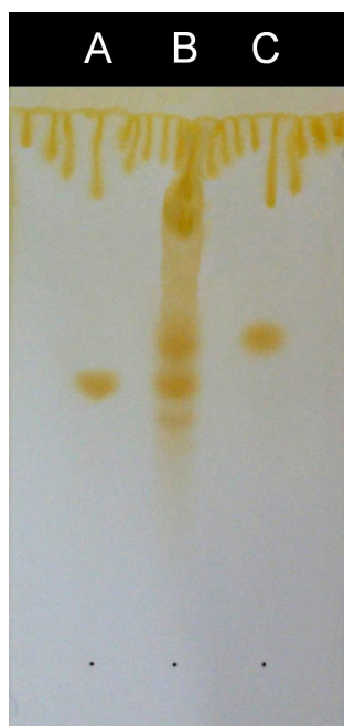
Figura 39 - Cromatograma realizado em sílica gel F 254 de extrato de boldo (B) e das substâncias boldina (A; R f =0,51) e ioimbina (C; R f =0,59). Os dados cromatográficos encontram-se descritos ao lado do cromatograma.
